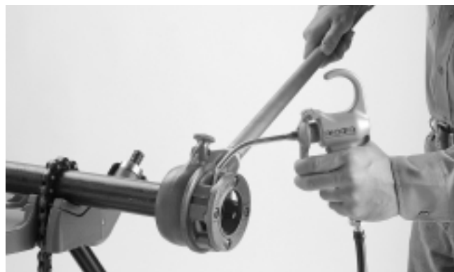
Figure 4 – Application de l'huile de coupe
