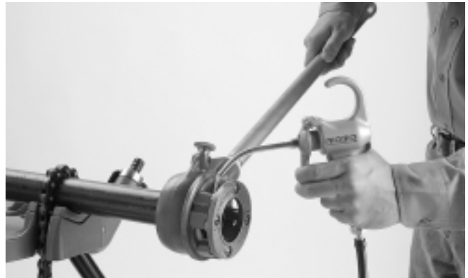
Figura 4 – Aceitado con aceite para cortar roscas
